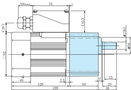
※适用橡皮绝缘软线的外径为  $\varphi 8 - \varphi 1\text{~}2$
