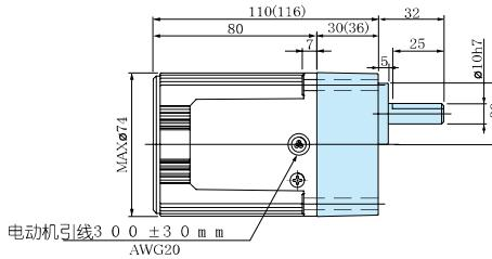
※ ( )内尺寸表示的是M X 7 G □B (M ) (减速比1 / 3 0 以上) 的尺寸。
