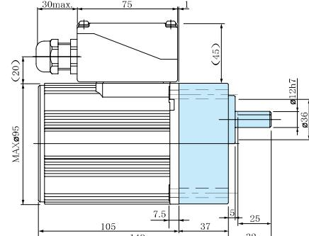
※适用橡皮绝缘软线的外径为  $\varphi 8 - \varphi 1\text{~}2$
