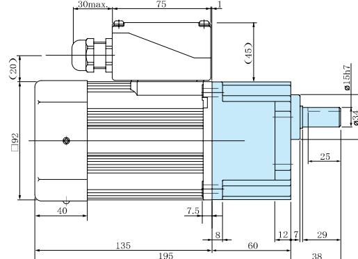
※适用橡皮绝缘软线的外径为  $\varphi 8 - \varphi 1\text{~}2$
