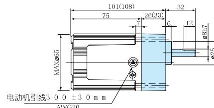
※ ( )内尺寸表示的是M X 6 G □B (M ) (减速比1 / 3 0 以上) 的尺寸。
